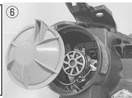
⑥ LEDバルブのソケットが、ヘッドライトユニット可動域の邪魔にならない位置にあるか再度確認してください。ランプユニットのカバーを元に戻してください。点灯テストを行い、正常に点灯・消灯することを確認し取外したパーツを取付け、光軸調整を行い、作業は終了となります。
