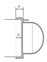
① ヘッドランプ開口部の外径を測定する。
