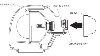
④ LED バルブ取付け後、純正 HID コネクターと LED バルブコネクターを 接続し、ゴムカバーをヘッドライトユニットへ取付けてください。 ※AFS 装着車に使用する場合はヘッドライトユニット可動域の邪魔になら ない位置に LED バルブコネクターを固定してください。
