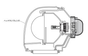
⑤ ゴムカバーを使用した LED バルブ取り付け完了状態です。 ゴムカバーがズレない様にタイラップやシリコン接着材などで固定していただく事をオススメします。 ※タイラップ、シリコン接着材は付属しません。
