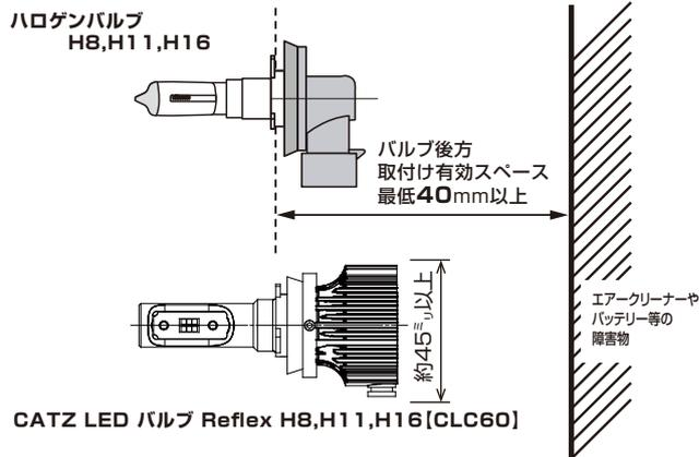
1：取付けに必要な有効寸法は車両電源コネクタの后端から **40mm以上**、**直径 45mm以上**のスペースが必要です。
